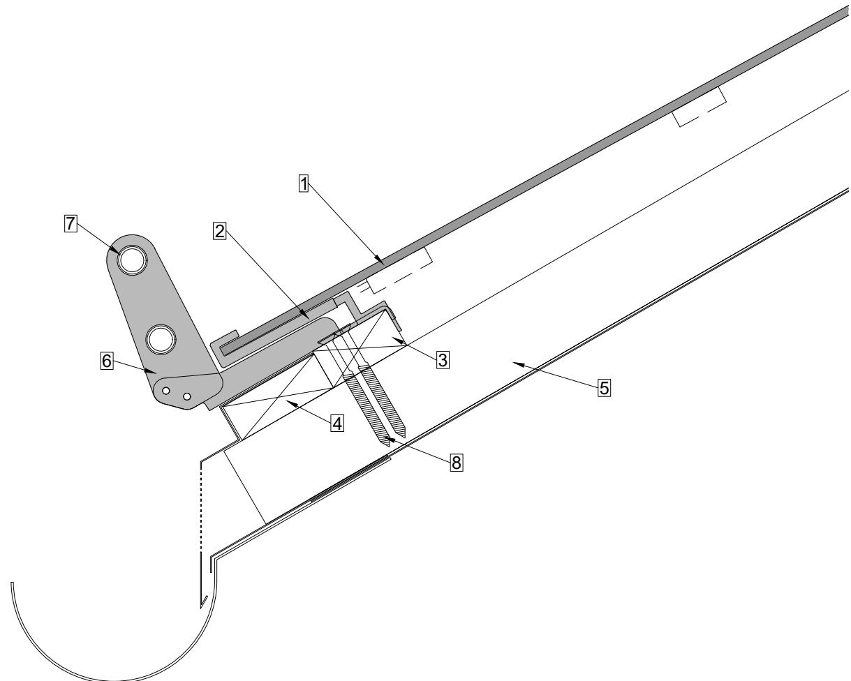
Schneehaken SEP wird unter jedem Haken platziert und in die Konterlattung verschraubt.
