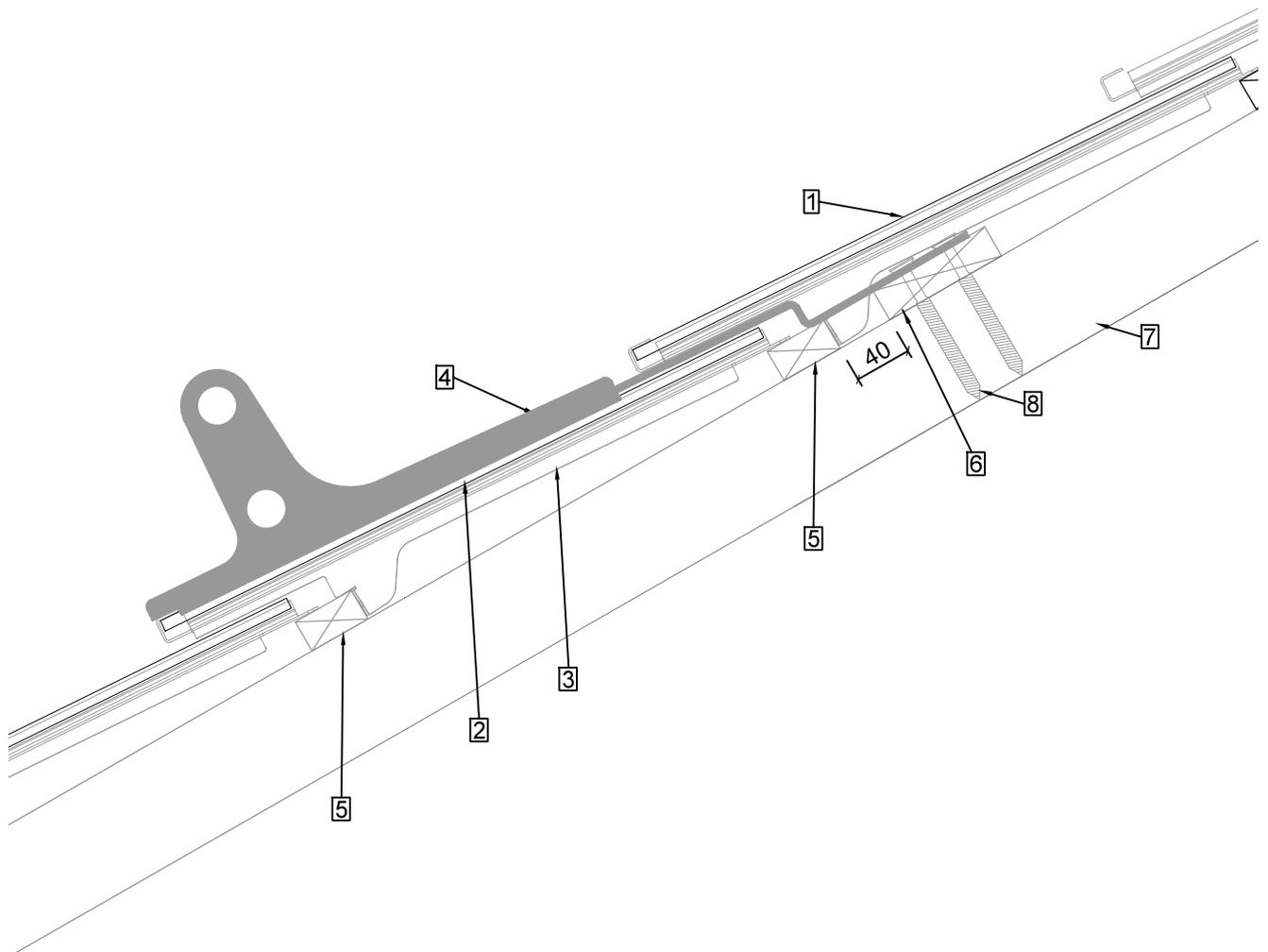
Der MATCH Schneefang im Feld wird jeweils über Blindmodulen, Inshapeplatten oder inaktiven Modulen montiert. Unter jedem MATCH Schneefang im Feld muss direkt darunter oder unmittelbar daneben ein MATCH slate Haken u/z montiert werden, um die Schneelast auf die Unterkonstruktion zu übertragen.
