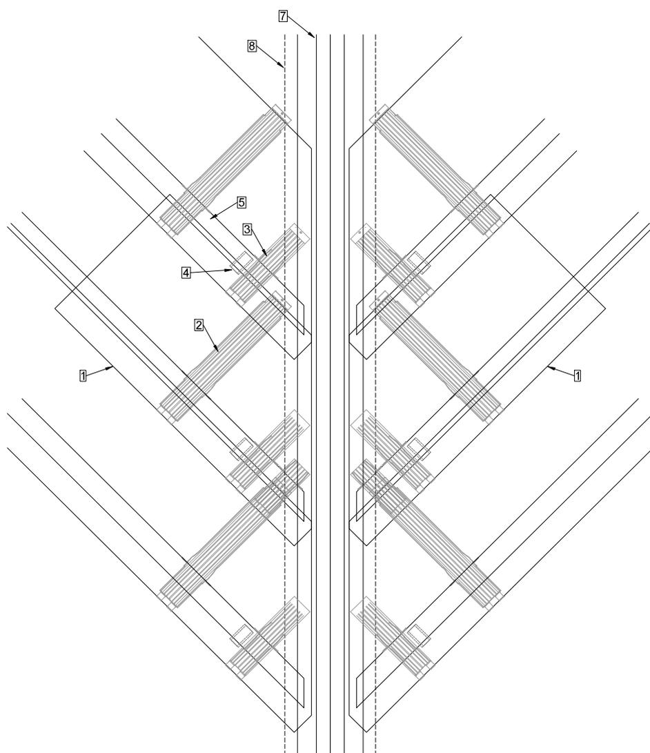
Die MATCH Klebe-Fixierung wird während der Modulmontage angebracht. Klebefläche muss vorgängig gereinigt werden.
