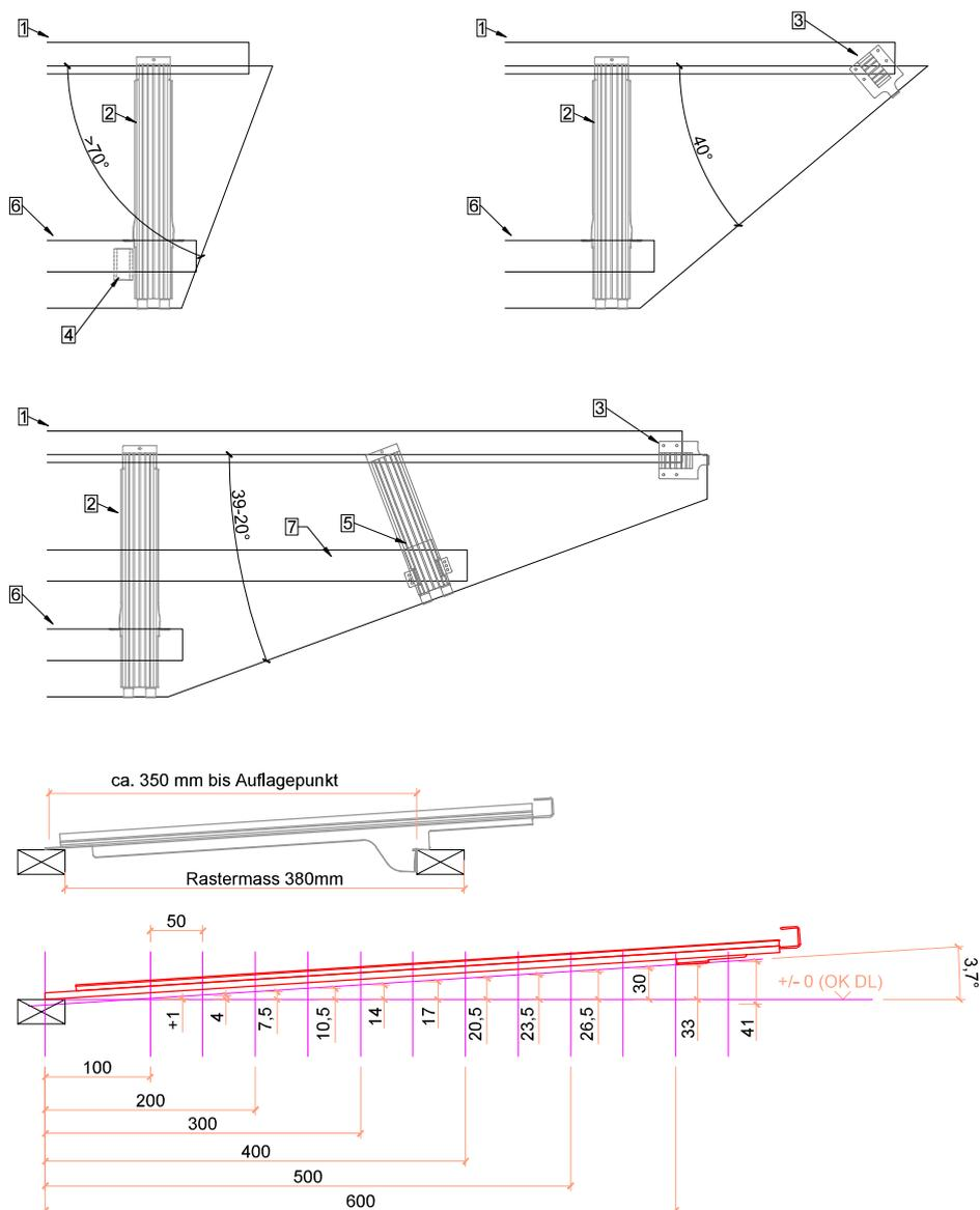
Die Auslegung der MATCH Slate Haken muss dem Modulwinkel angepasst werden.
