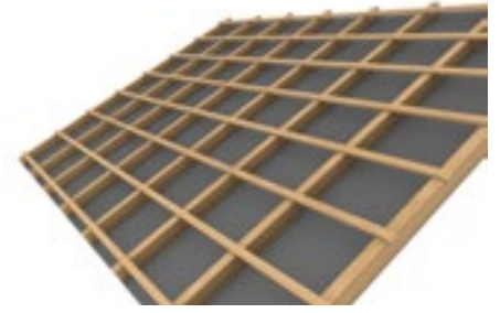
1 Preparare la listonatura del tetto
