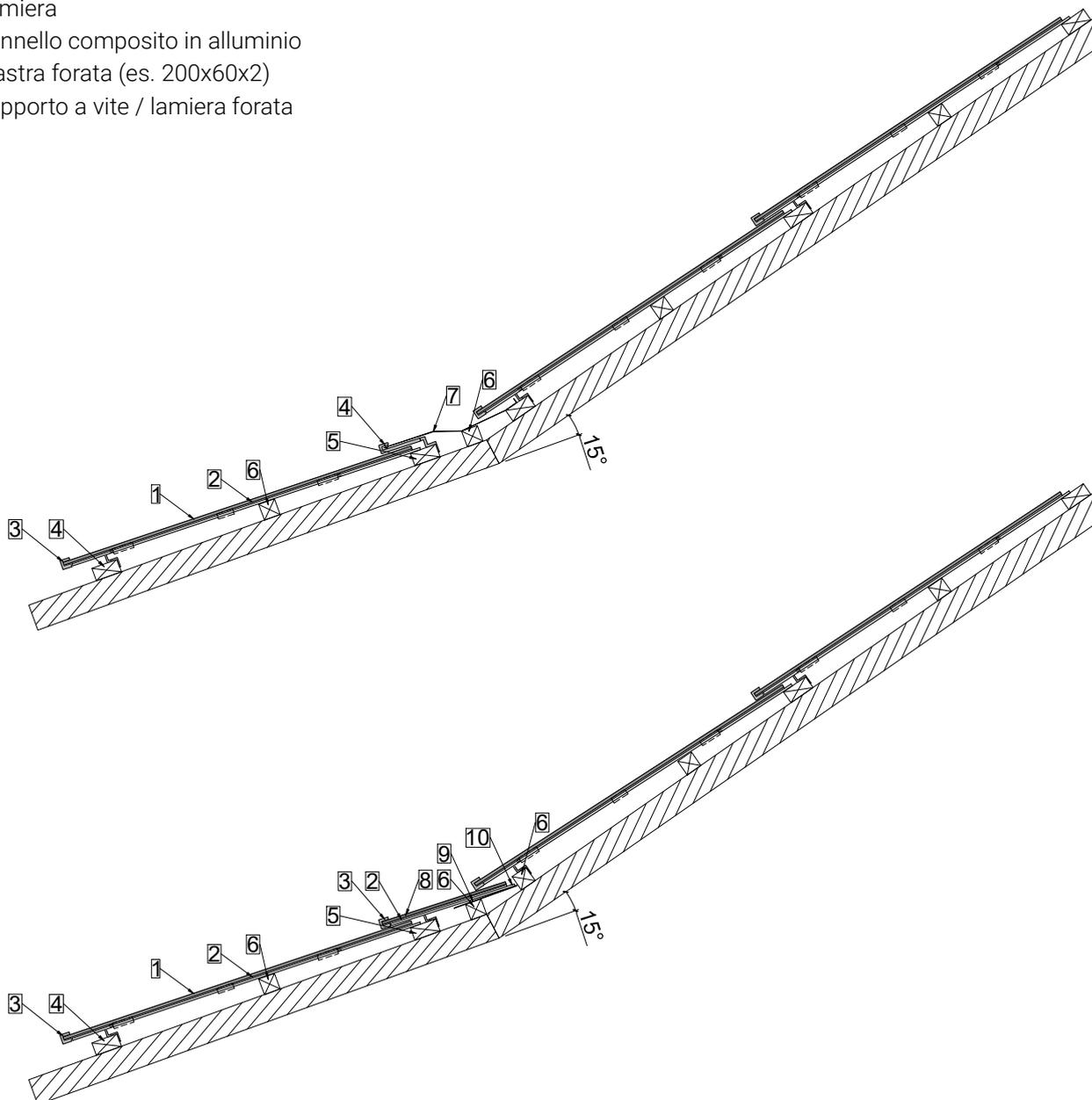
Possibilità di interruzione del tetto da 1° a 90°.
