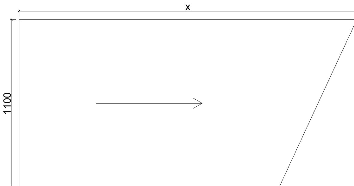
I moduli in alluminio composito LEVEL hanno un rivestimento nero opaco. Questo rivestimento è protetto da una pellicola. Posare i moduli in modo che le frecce sulla pellicola siano rivolte da sinistra a destra guardando il tetto dal davanti.
