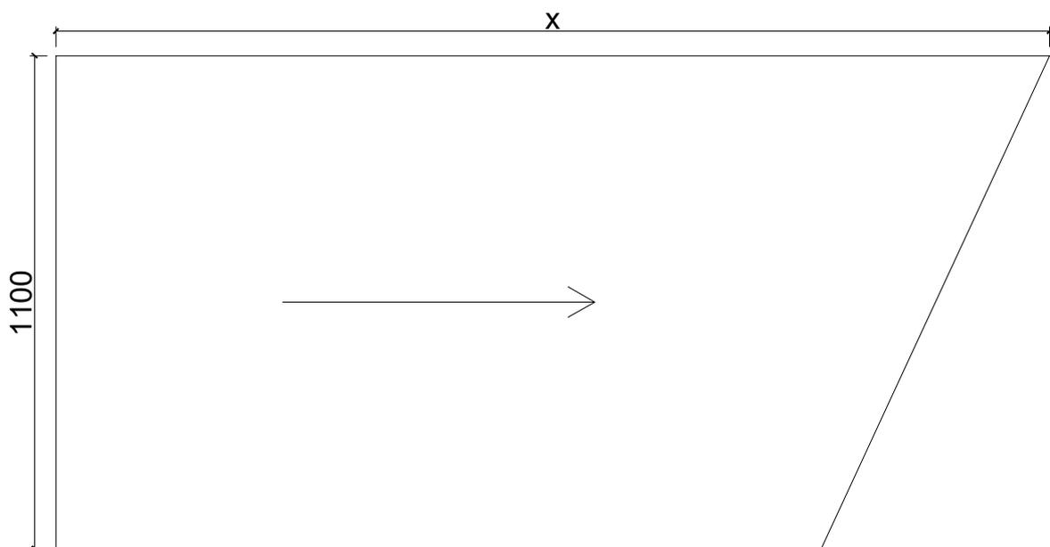
Die LEVEL Aluverbundmodule haben eine schwarze, matte Beschichtung. Diese Beschichtung wird mit einer Folie geschützt. Module jeweils so verlegen, dass die Pfeile auf der Folie von links nach rechts zeigen, wenn man das Dach von vorne betrachtet.
