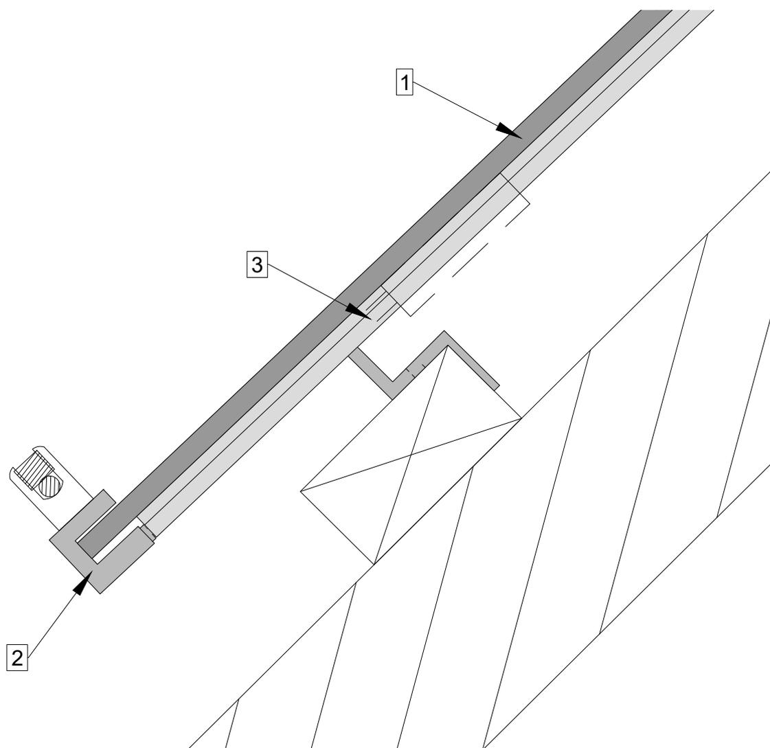
Hinweis: Auch bei sorgfältiger Planung und Ausführung des Blitzschutzanlage können im PV-Modul bei einem Blitzeinschlag sehr hohe Spannungen induziert werden, welche zur Beschädigung des PV-Moduls führen können. Der LEVEL Schienenhaken BliSchu ist eine Befestigungsmöglichkeit für den Blitzschutzdraht, welcher bei fachmännischer Auslegung das Gebäude schützen soll. Der Blitzschutz muss durch Spezialisten ausgelegt werden.
