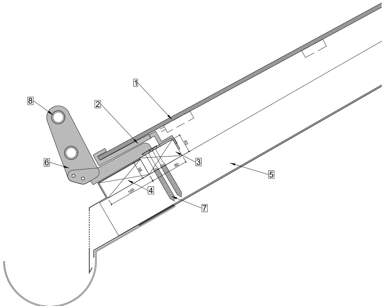
Schneehaken SEP wird unter jedem Haken platziert und in die Konterlattung verschraubt.
