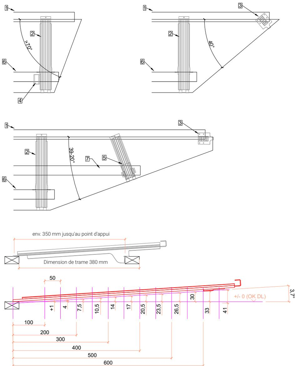
La conception des crochets MATCH Slate doit être adaptée à l'angle du panneau.
