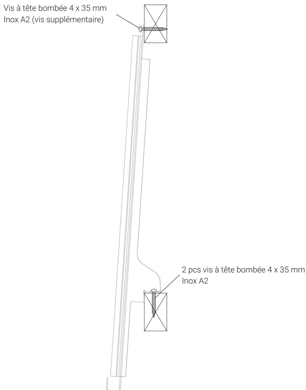
Les crochets MATCH sont chacun vissés sur le lattage du toit à l'aide de 2 vis. La vis du haut peut être fixée en plus, ce qui est recommandé surtout dans les rangées supérieures et dans les zones de bordure. Nous recommandons de visser le lattage du toit ainsi que le contre-lattage. La responsabilité de la statique de l'ensemble de la structure du toit incombe à l'entrepreneur chargé des travaux.
