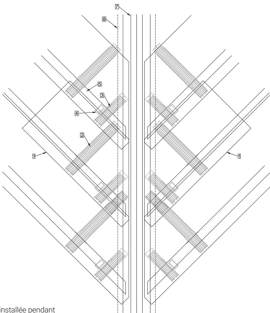
La fixation adhésive MATCH est installée pendant le montage des panneaux. La surface de collage doit être nettoyée au préalable.
