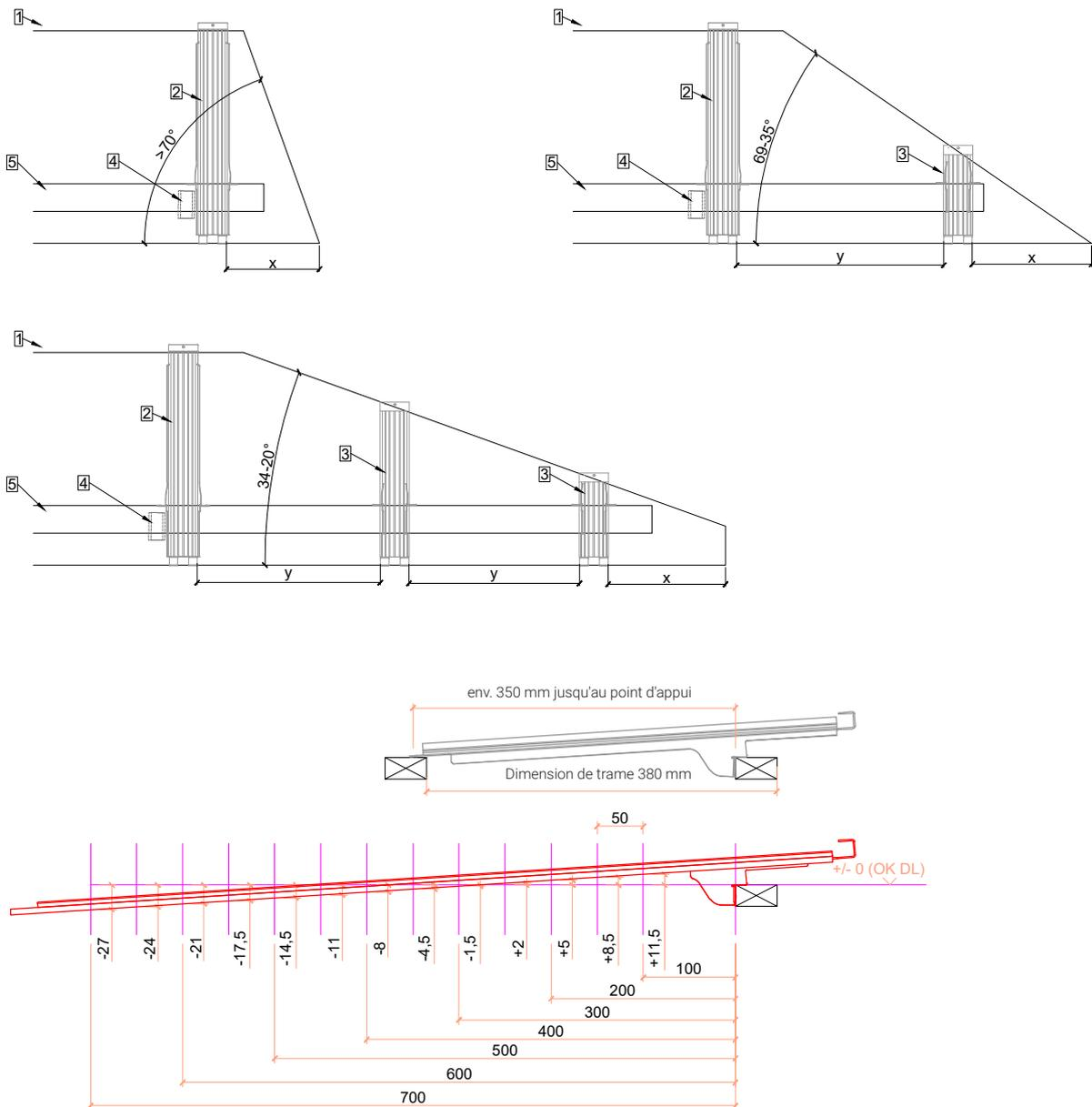
La conception des crochets MATCH Slate doit être adaptée à l'angle du panneau.
