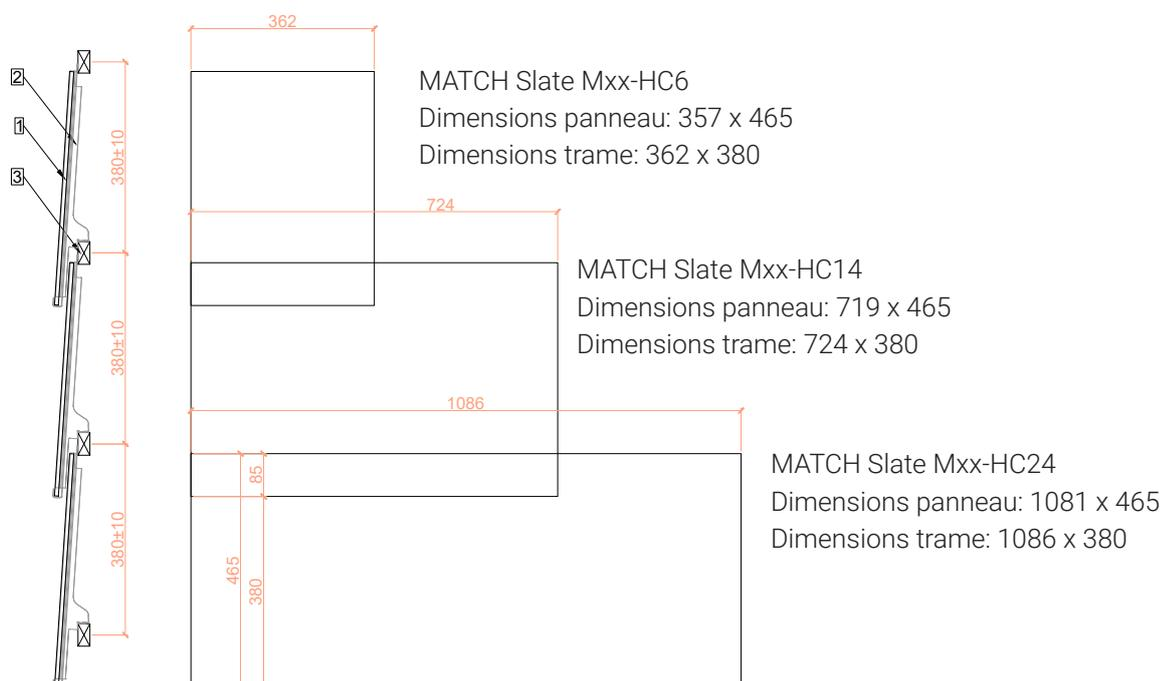
La dimension de trame verticale des panneaux MATCH Slate est de 380 mm, elle peut être ajustée de  $\pm 10$  mm.
