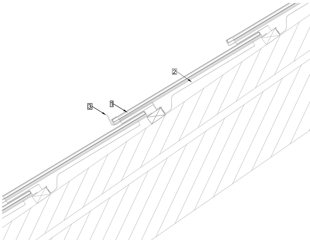
La Garde-neige SEP chéneau MATCH Slate est monté sur un crochet MATCH Slate z / u.
