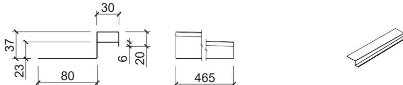
Tôle de transition haute pour MK06-SK06-MK10-SK10
