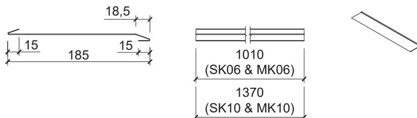
Épaisseur de tôle recommandée : 0.7mm
