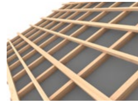
1 Les lattes de toit 80 x 40 et 50 x 50 sont installées en alternance dans la trame.
