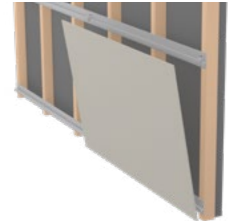
2 Positionner le panneau, inclinaison possible pour câblage.
