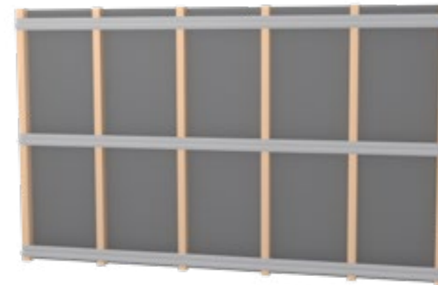
1 Fixer les profilés transversaux à la construction verticale.
