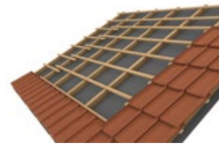
1 Préparer le lattage du toit
