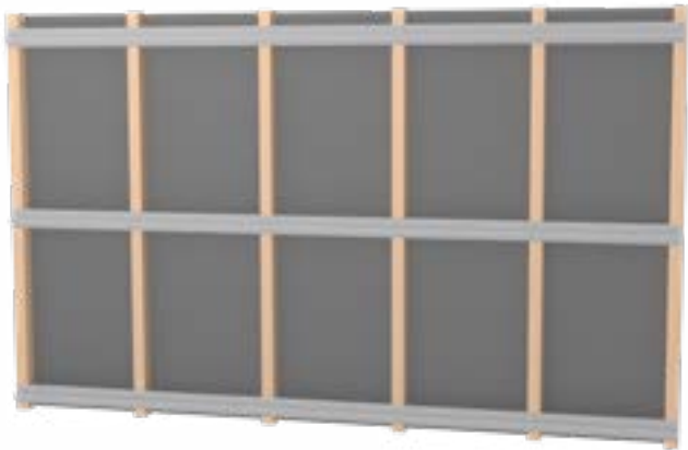
1 Querprofile an bauseitig vertikaler Konstruktion anbringen.
