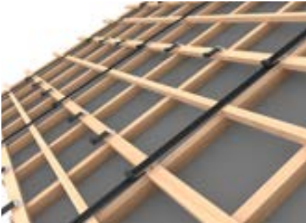
4 Mittelhaken sorgen für zusätzliche Stabilität.
