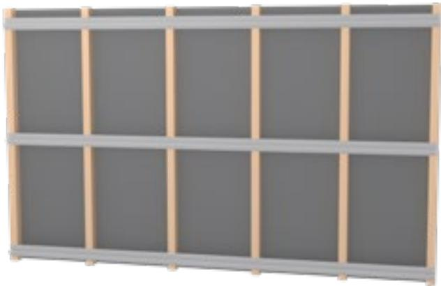
1 Querprofile an bauseitig vertikaler Konstruktion anbringen.
