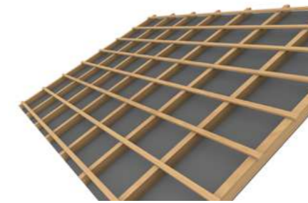
1 Preparare la listonatura del tetto
