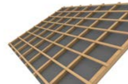
1 Preparare la listonatura del tetto
