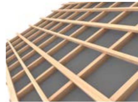
1 I listelli del tetto 80 x 40 e 50 x 50 sono montati alternativamente nella griglia.
