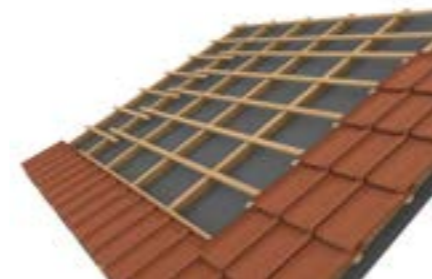
1 Preparare i listelli del tetto
