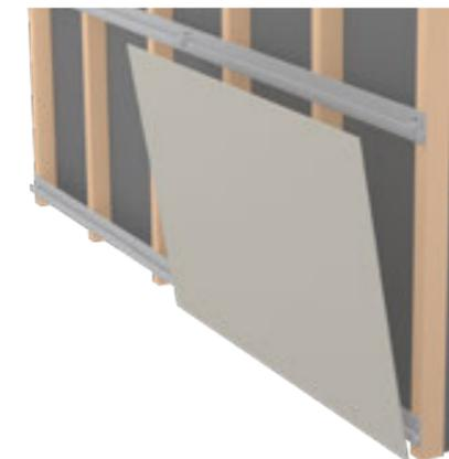
2 Positionner le panneau, inclinaison possible pour câblage.
