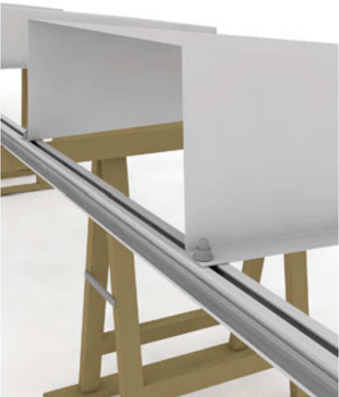
2 Flatport Wannen kopfüber auf die Träger legen und mit Flanschmutter M10 festschrauben.
