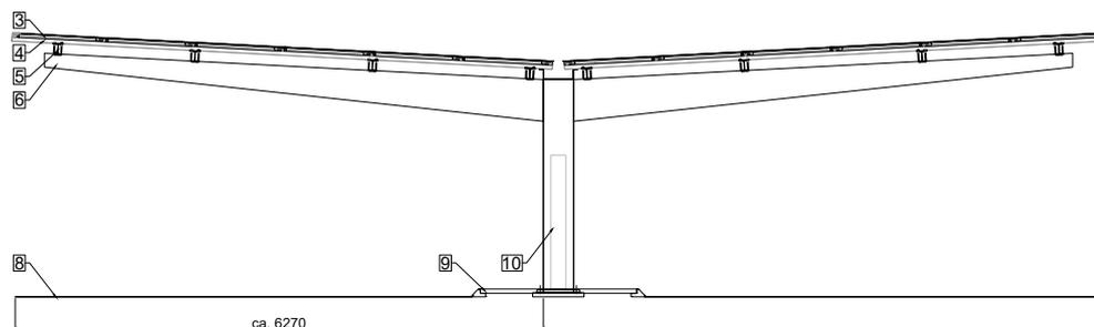
Le WingPort peut être dimensionné en fonction des besoins, car le concept de la solution est modulaire. L'unité de base SingleWing comprend deux places de stationnement, l'unité de base DoubleWing comprend quatre places de stationnement. Les dimensions recommandées des places de stationnement sont d'environ 6 x 2,5 m. Des dimensions individuelles sont bien évidemment possibles.
