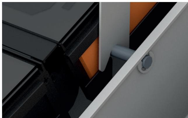
Mit dem NICER X Werkzeug kann die Klicksicherung einfach gelöst werden. So können wenn nötig einzelne Module unabhängig ihrer Position im Modulfeld ohne Probleme entsichert und ausgetauscht werden. Das NICER X Werkzeug ist ebenfalls dazu geeignet den Schieber der Klicksicherung ganz nach vorne zu schieben, falls dieser nicht von selbst vollständig nach vorne rückt.
