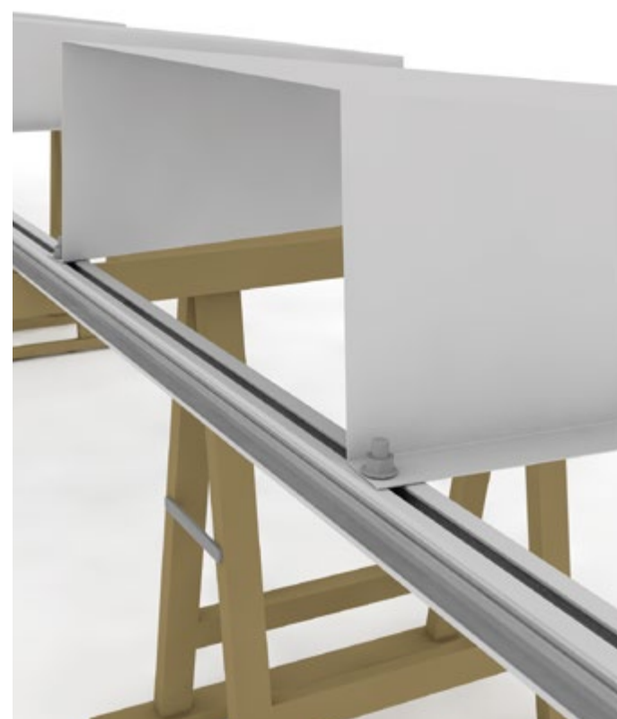
2 Placer les bacs Flatport à l'envers sur les profilés et serrer à l'aide de l'écrou à embase M10.
