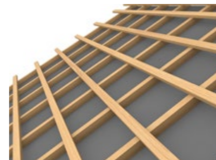
1 Une sous-construction en bois ou en acier sert de base.
