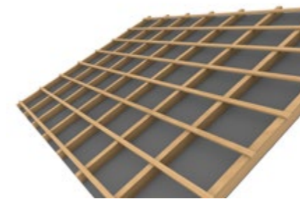
1 Préparer le lattage du toit.
