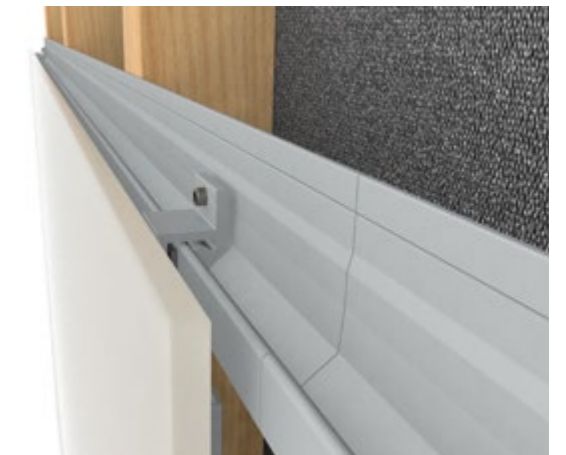
4 Sécuriser le panneau et positionner le panneau suivant.
