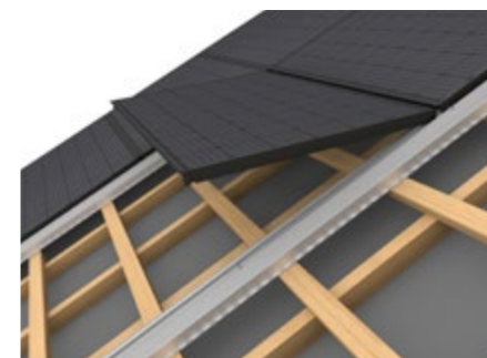
4 Les panneaux sont simplement encliquetés...
