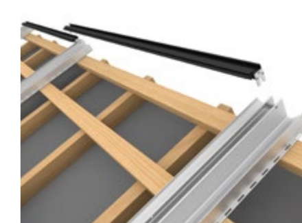
3 Les profilés de faîtage sont installés.
