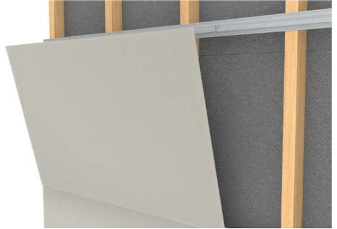
2 Positionner le panneau, inclinaison possible pour câblage.
